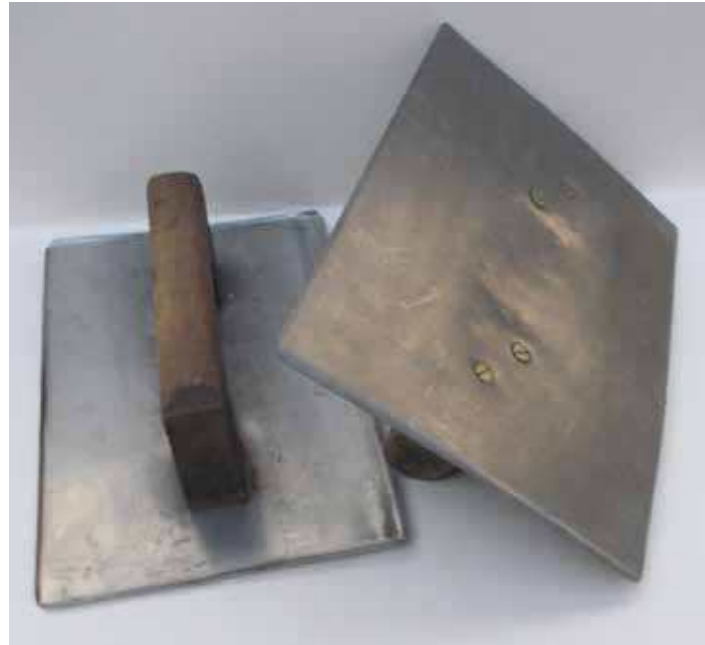
Abb. 9 - Scheiben zum Verfüllen und Glätten der Balken
